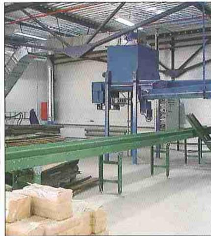
Siloanlage für die Aufbewahrung von Spänen und Staub entweder für Brikettierung, Verbrennungsanlage oder Abholung, wir haben die Lösungen und ein zugelassenes Siloprogramm für alle Bedürfnisse.
