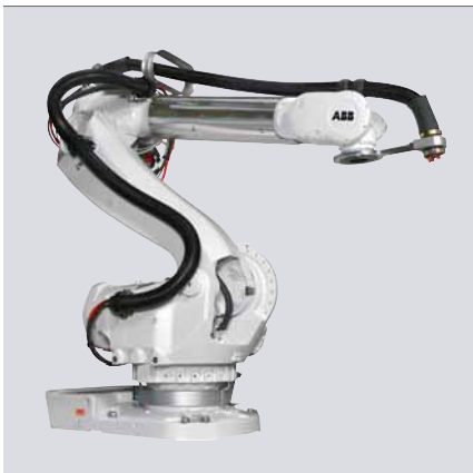
5 Der 1991 eingeführte IRB 6000 mit seinem modularen Aufbau wurde zum meistverkauften Punktschweißroboter von ABB.
