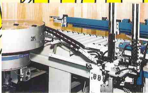
Systemes d'alimentation pour groupes d'insertion charnières. Beschickungssystem für scharnier-eintreibgruppe.
