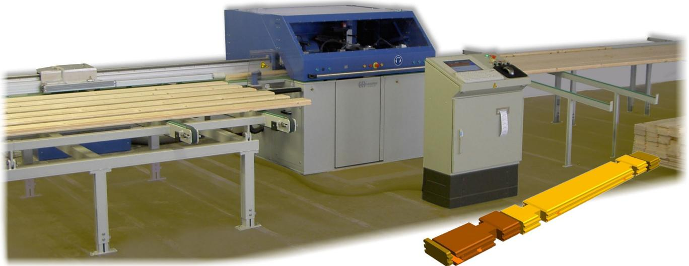
Automatische Blockhausfräse BL100A zum rationellen Erzeugen von Bauteilen für den modernen Blockhausbau. Die Bearbeitungen umfassen den Längenzuschnitt, das Fräsen der verschiedenen Verbindungen sowie das Herstellen von Bohrungen.
