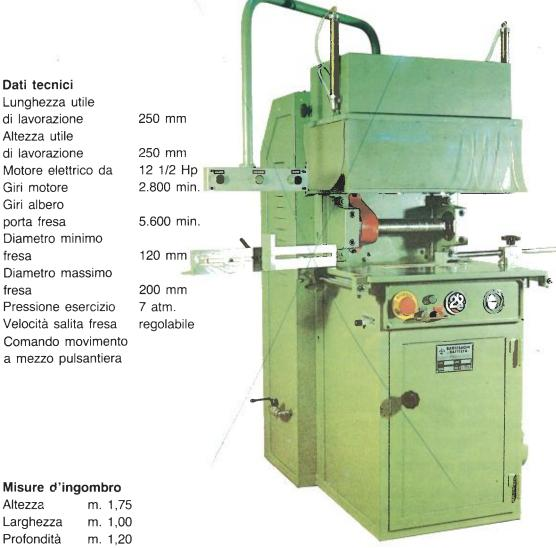
È la fresatrice ideale per ogni tipo di lavorazione per la costanza del movimento della fresa dato dall'apparecchiatura idraulica. Viene costruita con doppio sistema di lavorazione poichè è possibile fresare i pezzi sia dal basso verso l'alto (lavorazione preferibile) che dall'alto verso il basso.
