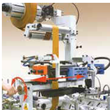
Lateral adjustment system. (PUR)
