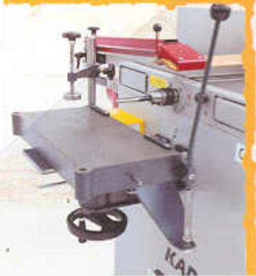
In wenigen Minuten kann die Langlochbohrereinrichtung angebaut oder abgenommen werden.
