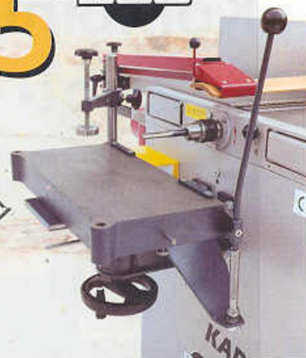
Langlochbohrereinrichtung sind an alle BGU kombinierten Hobelmaschinen anbaubar.
