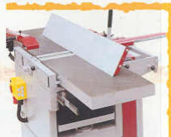
Der besonders große starkwandige Abricht- und Fügeanschlag, 1,30 m lang, aus gezogenem, starkwandigem Aluminiumprofil, läßt sich über die gesamte Tischbreite verstellen. Er kann sehr exakt durch Schwenkverstellung stufenlos von 90° bis 45° verstellt werden.
