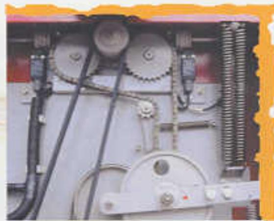
Die Handwerkermaschine KAD 532 ist mit starken Federn zum Entlasten der Abrichttische beim Umstellen ausgestattet. Spielend leicht lassen sich Abrichttische beim Umstellen auf Dickenhobeln aufklappen.
