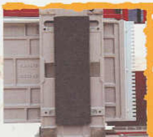
An den Maschinenteilen angebrachte Schaumstoffpolsterungen sorgen für besondere Laufruhe und Staubabdichtung. Staubfreies Arbeiten in Verbindung mit einer Absauganlage ist sowohl beim Dickenhobeln als auch beim Abrichten gewährleistet.
