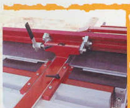
Der Anschlag, 1,10 m lang aus starkwandig gezogenem Aluminiumprofil, ist bis 45° schrägstellbar und läßt sich über die gesamte Tischbreite verstellen.
