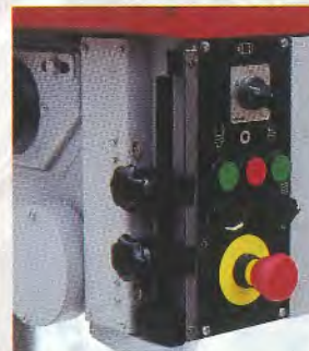
TB 230/10 R Automatische Reversiereinrichtung für Gewindeschneidarbeiten bis M 10.
