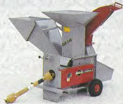
GSZ 242 mit Oben- und Untenauswurf Trommelbreite 240 mm Für Traktoranschluss Antrieb über Gelenkwelle Äste bis Ø max. 12 cm
