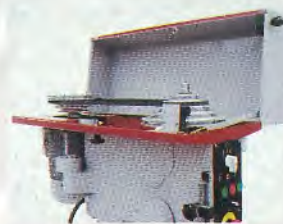
TB 230/10 R Drehzahlverstellung mittels Stufenscheibe und polumschaltbarem Motor.
