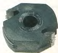
Verleimfräser mit 2 HSS-Schneiden, 100 x 50 mm, Bohrung 30 mm Ø, Art. Nr. 91027
