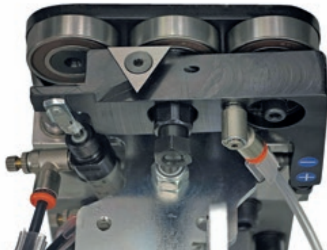
El Grupo Rascador de Cola , que retira la parte sobrante de cola en las partes superior e inferior del panel.
