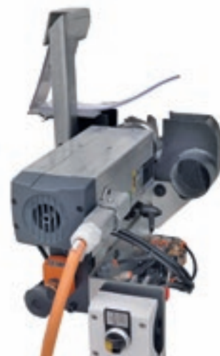
El Grupo Fresador permite realizar el ranurado y el fresado en la superficie inferior del panel.
