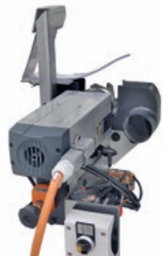
Il Gruppo Fresatore permette di realizzare la scanalatura e la fresatura sulla superficie inferiore del pannello.
