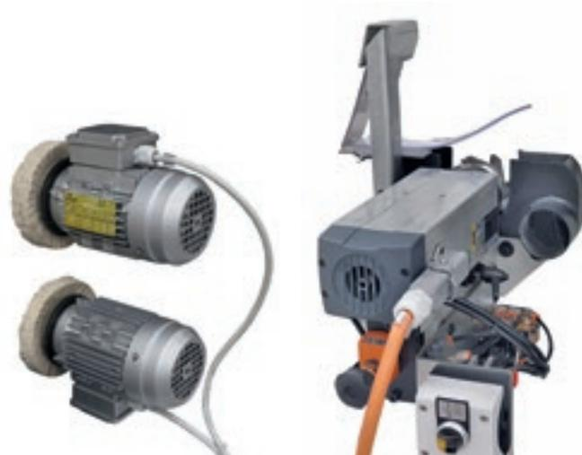
Щёточная группа для очистки и полировки кромки и панели.
