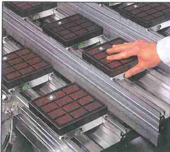
Universal jigs with pneumatic release for panels of different dimensions (optional). Als Anschlag oder Spanner einsetzbare Doppelfunktionsvorrichtung für die Feststellung von schmalen Teilen (wahlfrei).
