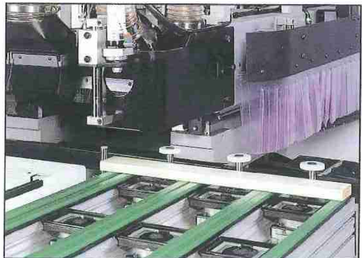
Device with double function as stop/clamp for pneumatic clamping of narrow pieces (optional). Als Anschlag oder Spanner einsetzbare Doppelfunktionsvorrichtung für die Feststellung von schmalen Teilen (wahlfrei).
