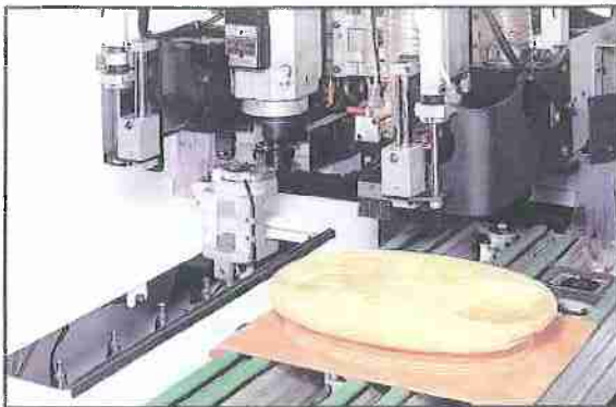
5-piece Tool-magazine with access allowed for 2 electro-spindles. Werkzeugmagazin mit 5-Plätzen, in dem 2 Elektrospindeln benutzt werden können.
