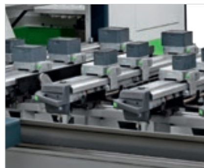
ATS (高级的台面设置系统) 应用于快速、简便的手动定位夹紧系统
