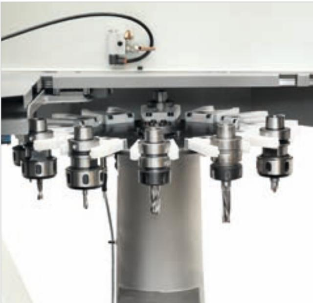
Jusqu'à **24 agrégats et outils** disponibles sur la machine. L'intervention de l'opérateur pour l'outillage n'est pas requise pour passer d'un façonnage à l'autre.
