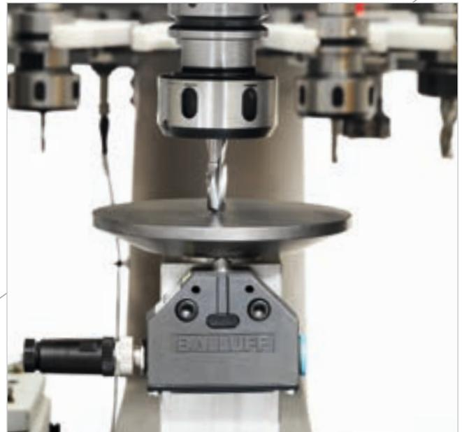
Réduction des temps d'outillage machine sans erreurs de la part de l'opérateur grâce au **Présélecteur à contact** qui permet de mesurer automatiquement la longueur de l'outil.
