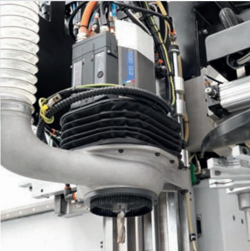
Des **électrobroches** allant jusqu'à 36 000 tours/min pour la puissance et la rapidité des prestations.
