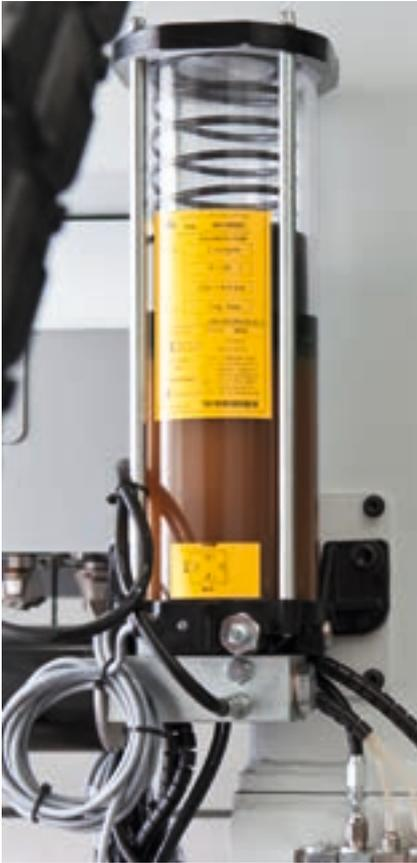
La **lubrification automatique** est une option qui garantit une lubrification continue des principaux organes d'actionnement de la machine sans l'intervention de l'opérateur.
