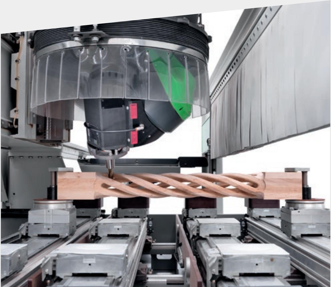
Unidad de fresado de 5 ejes con capuchón regulable en altura de 360 mm.
