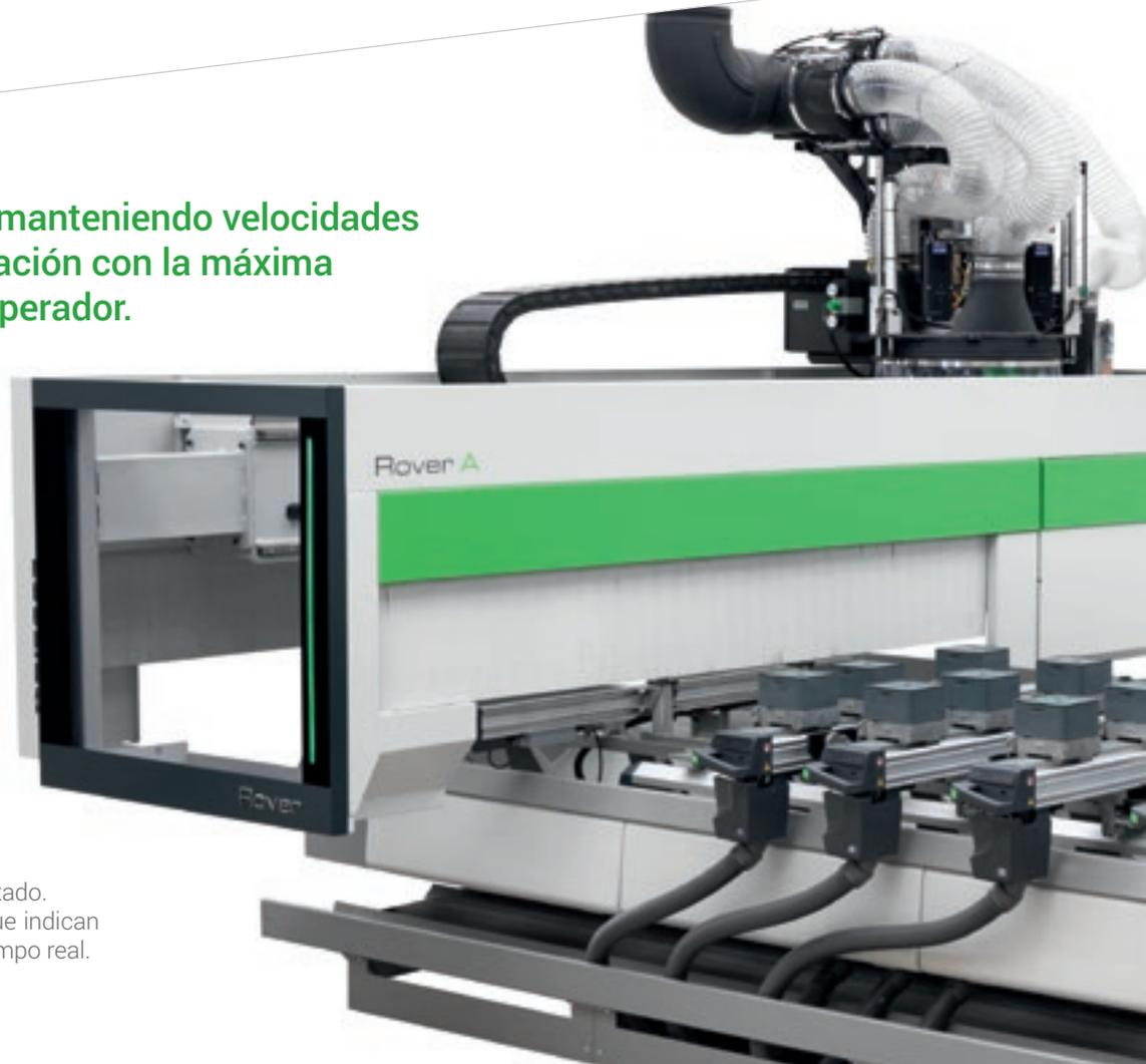
Máxima visibilidad de mecanizado. Banda de LED de 5 colores que indican el estado de la máquina en tiempo real.
