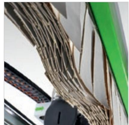
**Bandas laterales** para la protección del grupo operador, móviles para trabajar a la máxima velocidad con seguridad total.
