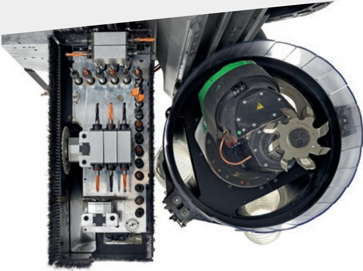
El nuevo cabezal de taladro BH29 2L está dotado de lubricación automática y refrigerado por líquido para asegurar la máxima precisión.
