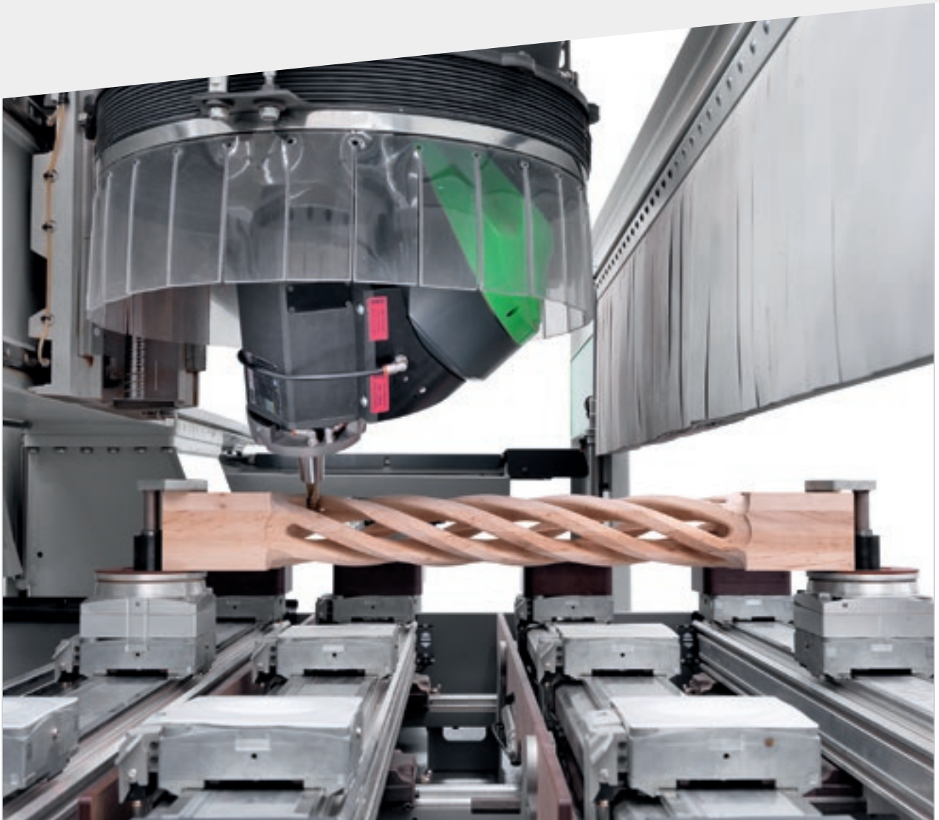
Unité de fraisage à 5 axes avec coiffe réglable en hauteur de 360 mm.
