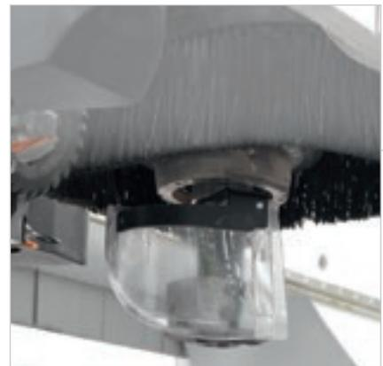
**Integriertes CNC-gesteuertes Späneleitblech (Späneleitsystem).**
