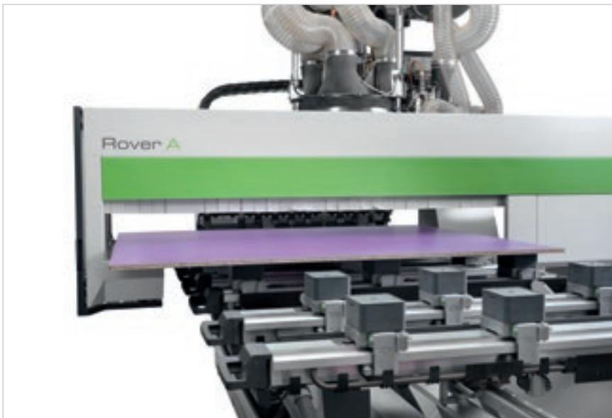
Durch die Zuführungsmöglichkeit von 1900 mm dicken Platten kann die Vor-Trennphase vermieden werden und es können Bearbeitungen von Werkstücken durchgeführt werden, die größer sind als der Arbeitsbereich, in doppelter Positionierung.
