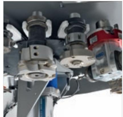
**Revolver-Werkzeugmagazin mit 16 Aufnahmen am Schlitten X** für ständige Verfügbarkeit von Werkzeugen und Aggregaten. Ausgestattet mit Schutzabdeckung für die Werkzeuge mit automatischer Öffnung.
