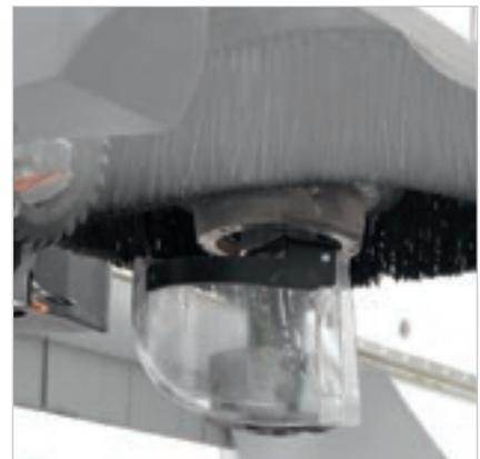
**Integriertes CNC-gesteuertes Späneleitblech** (Späneleitsystem).
