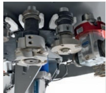
**Revolver-Werkzeugmagazin mit 16 Aufnahmen am Schlitten X** für ständige Verfügbarkeit von Werkzeugen und Aggregaten. Ausgestattet mit Schutzabdeckung für die Werkzeuge mit automatischer Öffnung.
