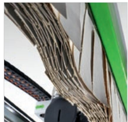
**Seitliche bewegliche Schutzbänder** zum Schutz der Arbeitsgruppe, für ein vollkommen sicheres Arbeiten bei maximaler Geschwindigkeit.
