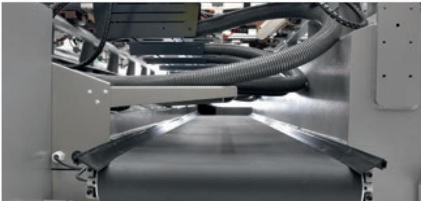
**Motorisiertes Förderband** zum Abtransport von Spänen und Bearbeitungsabfällen.
