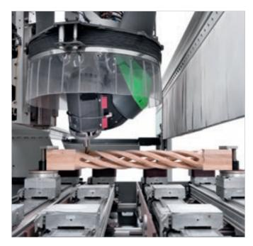
Unità di fresatura 5 assi con cuffia regolabile in altezza di 360 mm.
