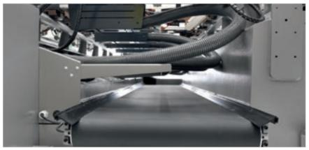
Tappeto motorizzato per la rimozione di trucioli e sfridi.
