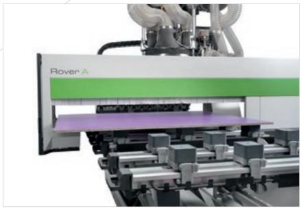
La possibilità di caricare pannelli da 1900 mm di profondità consente di evitare la fase di pre-sezionatura e di eseguire lavorazioni di pezzi più grandi dell'area di lavoro in doppio posizionamento.
