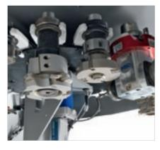
Magazzino utensili a Revolver a 16 posti a bordo carro X per avere utensili e aggregati sempre disponibili. Dotato di copertura di protezione degli utensili ad apertura automatica.
