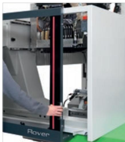
Protezione integrale del gruppo operatore. L'ampio sportello apribile garantisce la massima visibilità di lavorazione e facilità di accesso ai gruppi operatori.
