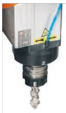
Motore verticale fisso dedicato a lavorazioni accessorie di fresatura (slot, antiscaglia, ...).
