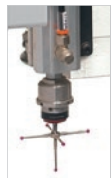
Tastatore a 5 sonde consente di rilevare con la massima precisione le dimensioni del pannello.
