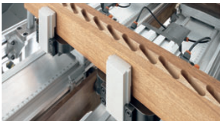
Bearbeitung von Fensterlädenl.
