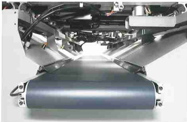
Vorrichtungen zur automatischen Späne- und Abfallbeseitigung, die während der Bearbeitungen abfallen.
