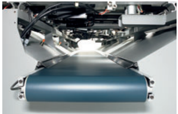
Dispositivi per la rimozione automatica del truciolo e degli sfridi prodotti dalla lavorazione.
