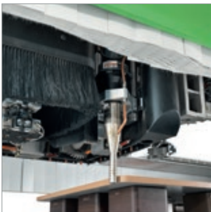
Groupe souffleur à air froid ou chaud pour raviver la couleur du chant.
