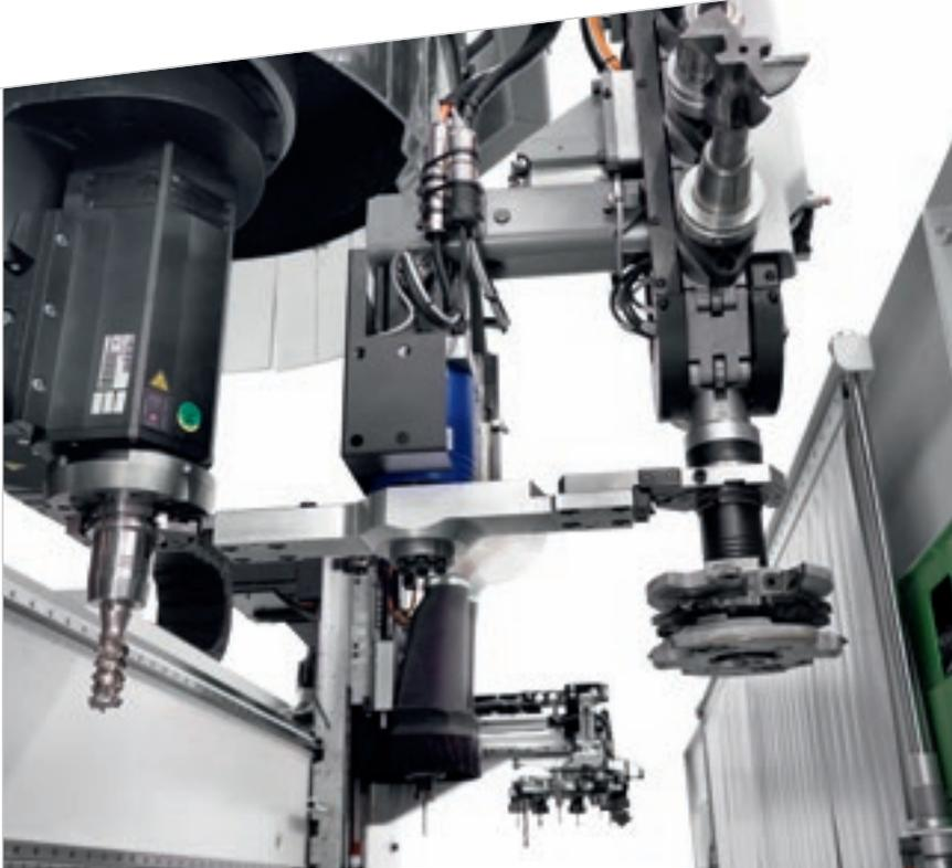
Almacén de herramientas de cadena vertical en el eje Y de 10-15 posiciones.
