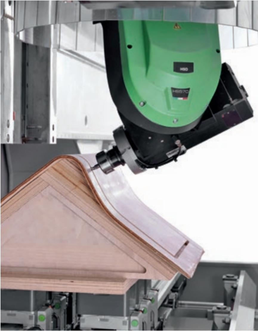
Posibilidad de mecanizar componentes de gran espesor gracias al paso pieza de 400 mm.
