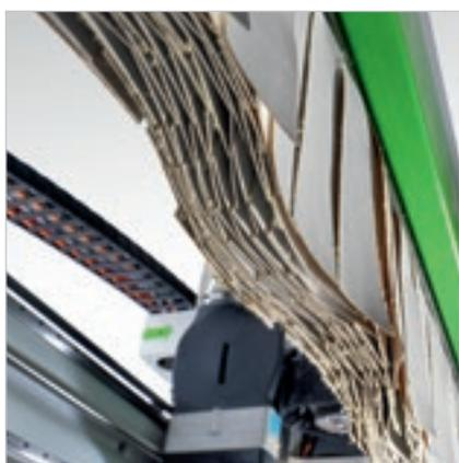
Bandas laterales para proteger el grupo operador, móviles para trabajar con la máxima velocidad con total seguridad.
