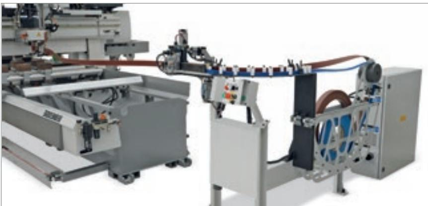
Cambio rápido de las bobinas con almacén de cantos ubicado fuera de la red de protección.
