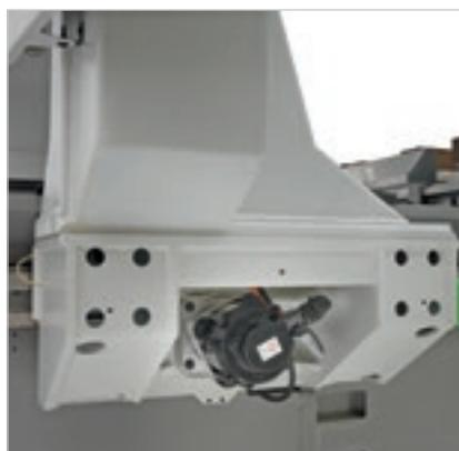
La doble motorización en el eje X permite alcanzar altas velocidades y aceleraciones, manteniendo una alta precisión y calidad de acabado.
