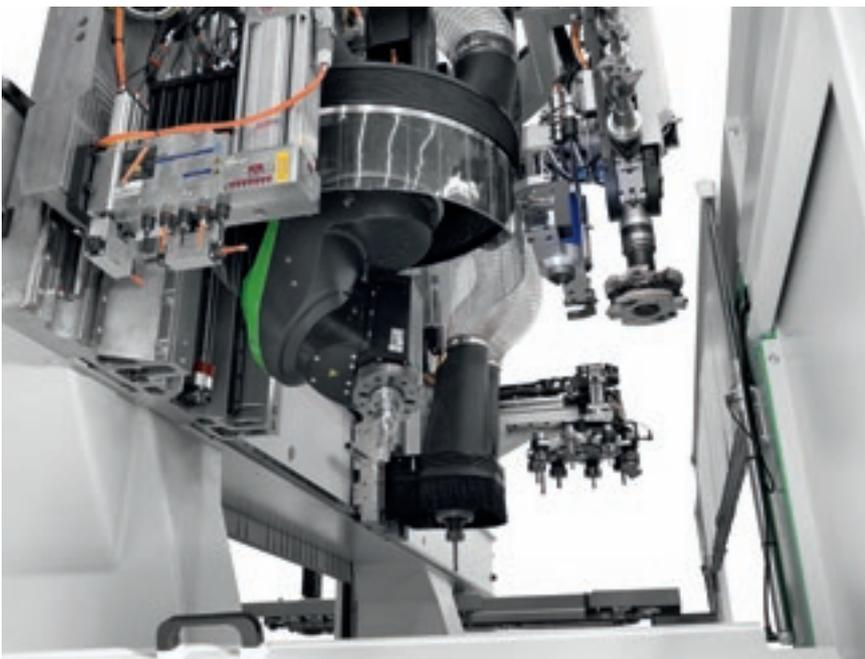
La posible combinación de los grupos 5 ejes y 4 ejes permite procesar cualquier tipo de producto. Los ejes Y independientes permiten realizar cambios de herramientas mientras se realizan otras operaciones utilizando el mayor número de herramientas disponibles en la máquina.
