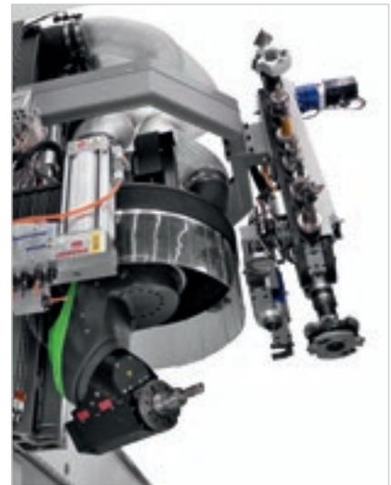
Los ejes Y independientes permiten realizar cambios de herramientas mientras se realizan otras operaciones utilizando el mayor número de herramientas disponibles en la máquina. La lanzadera presente en el almacén de cadena vertical permite una rápida ejecución del cambio de herramienta.
