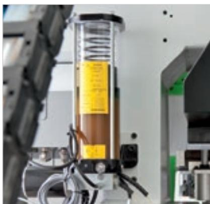
La lubricación automática garantiza una continua lubricación de las principales partes móviles de la máquina sin necesidad de que intervenga el operario.
