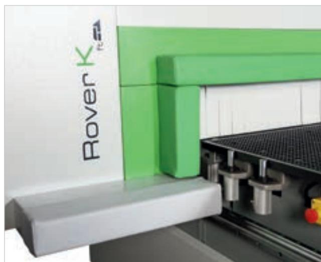
Die neue volle Bumper Lösung ermöglicht den jederzeitigen Zugang zum Arbeitstisch von allen Seiten unter absolut sicheren Bedingungen.
