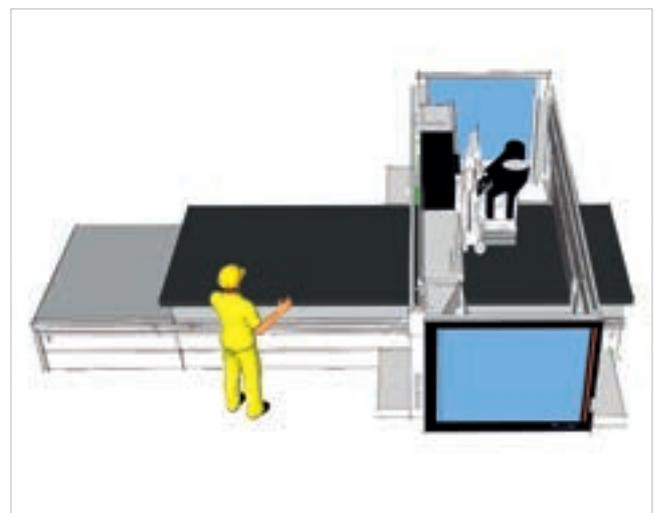
Die Maschine kann mit der Pendelfunktion konfiguriert werden, um Platten auf den gegenüberliegenden Ausgangspunkten abwechselnd zu bearbeiten und somit die Be- und Entladearbeiten ohne Ausfallzeiten durchzuführen.
