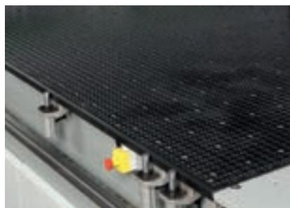
Arbeitstisch aus geschichtetem Kunststoff mit Vakuumanlage.
