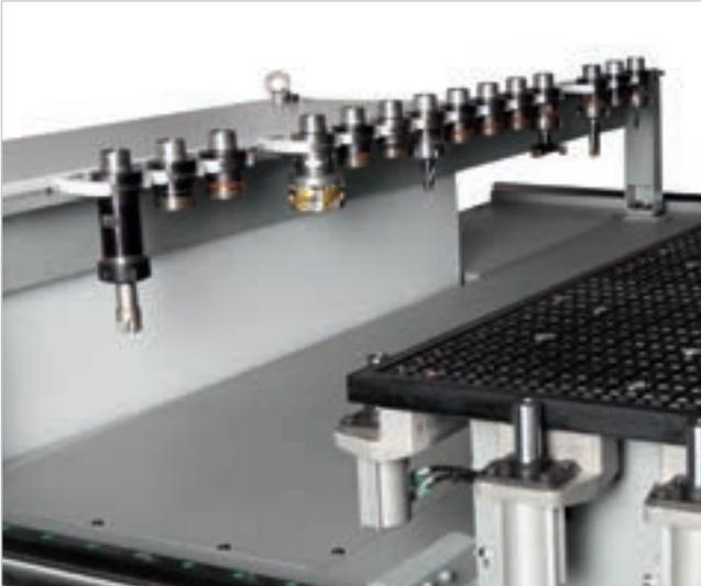
Mit dem Werkzeugmagazin mit 14 Aufnahmen stehen Werkzeuge und Aggregate für den Wechsel von einer Bearbeitung zur nächsten immer zur Verfügung, ohne dass ein Eingriff des Bedieners für die Bestückung erforderlich ist.
