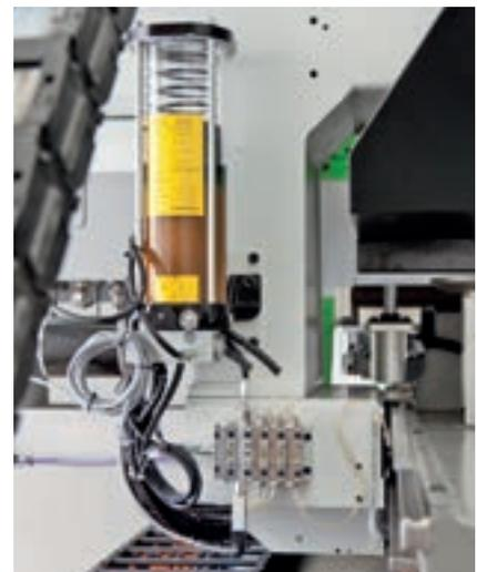
Die automatische Schmierung ist eine Option, die eine ständige Schmierung der wichtigsten Bewegungselemente der Maschine ohne Eingriff des Bedieners gewährleistet.
