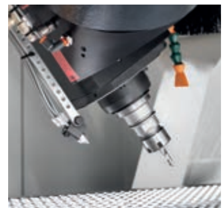
System Air Jet , das das Werkzeug mit Luft bei -14^{\circ} kühlt und erlaubt, dass das Werkzeug niemals überhitzt oder das Material verklebt.
