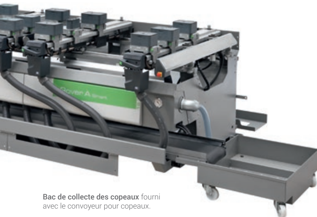
Défecteur (transporteur de copeaux) géré par contrôle numérique
