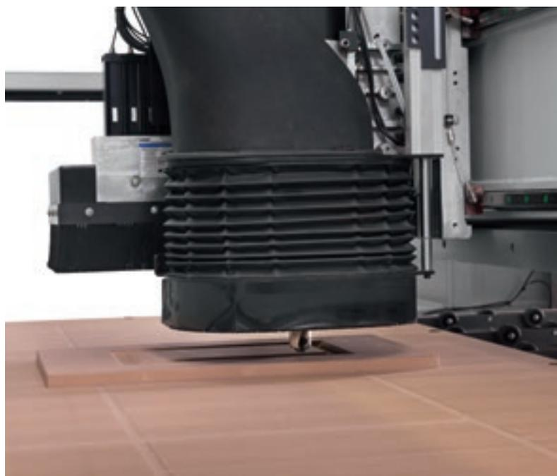
Cuffia di aspirazione con 12 posizioni programmabili e l'uso di un rivestimento continuo per la massima capacità di aspirazione.
