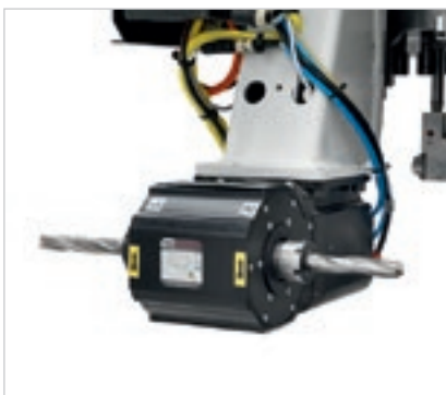
Horizontaler Motor mit 2 Ausgängen für Schlossausparungen und horizontale Bearbeitungen.
