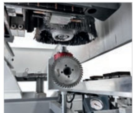
Der Pick Up Wechsler gestattet die Bestückung der Magazine in der Maschine.
