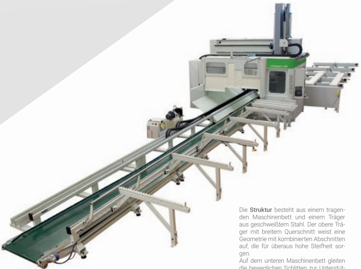
Die **Struktur** besteht aus einem tragenden Maschinenbett und einem Träger aus geschweißtem Stahl. Der obere Träger mit breitem Querschnitt weist eine Geometrie mit kombinierten Abschnitten auf, die für überaus hohe Steifheit sorgen. Auf dem unteren Maschinenbett gleiten die beweglichen Schlitten zur Unterstützung des Trägers in Bearbeitung.
