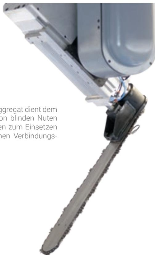
Das Kettenaggregat dient dem Ausführen von blinden Nuten oder Schlitzern zum Einsetzen von metallenen Verbindungsplatten.
