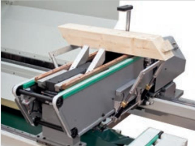
Das **Trägervorschubsystem** umfasst vier mit einem vertikalen und horizontalen ölhydraulischen Einspannsystem ausgestattete Schlitten.
