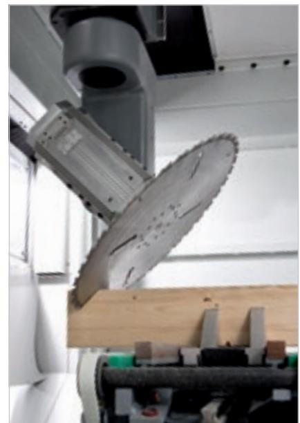
**Spezielle Sägeblattgruppe** mit Durchmesser 735 mm auf 5 gesteuerten Achsen.
