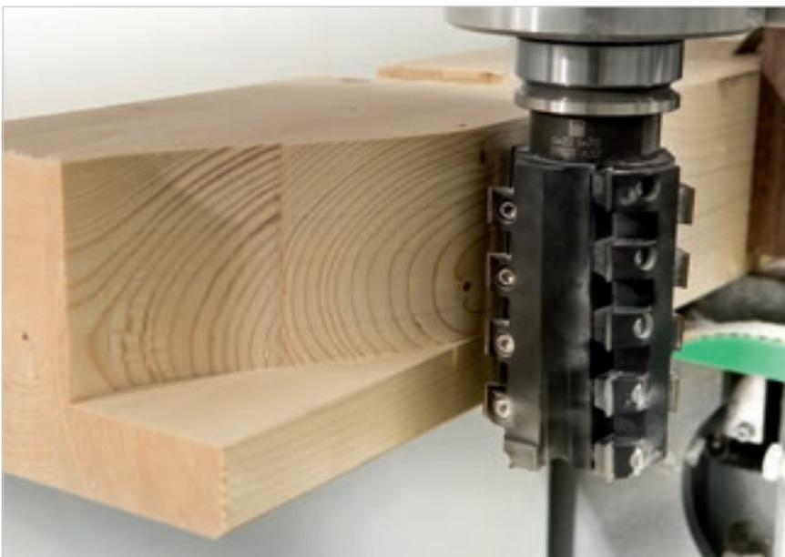
**Fräseinheit mit 5 Achsen**, 17 kW, die dank des auf der Spindelachse positionierten Encoders für die Kontrolle der Stromaufnahme abhängig vom Werkzeugvorschub in der Lage ist, der Bearbeitung sehr großer und schwerer Werkstücke standzuhalten.
