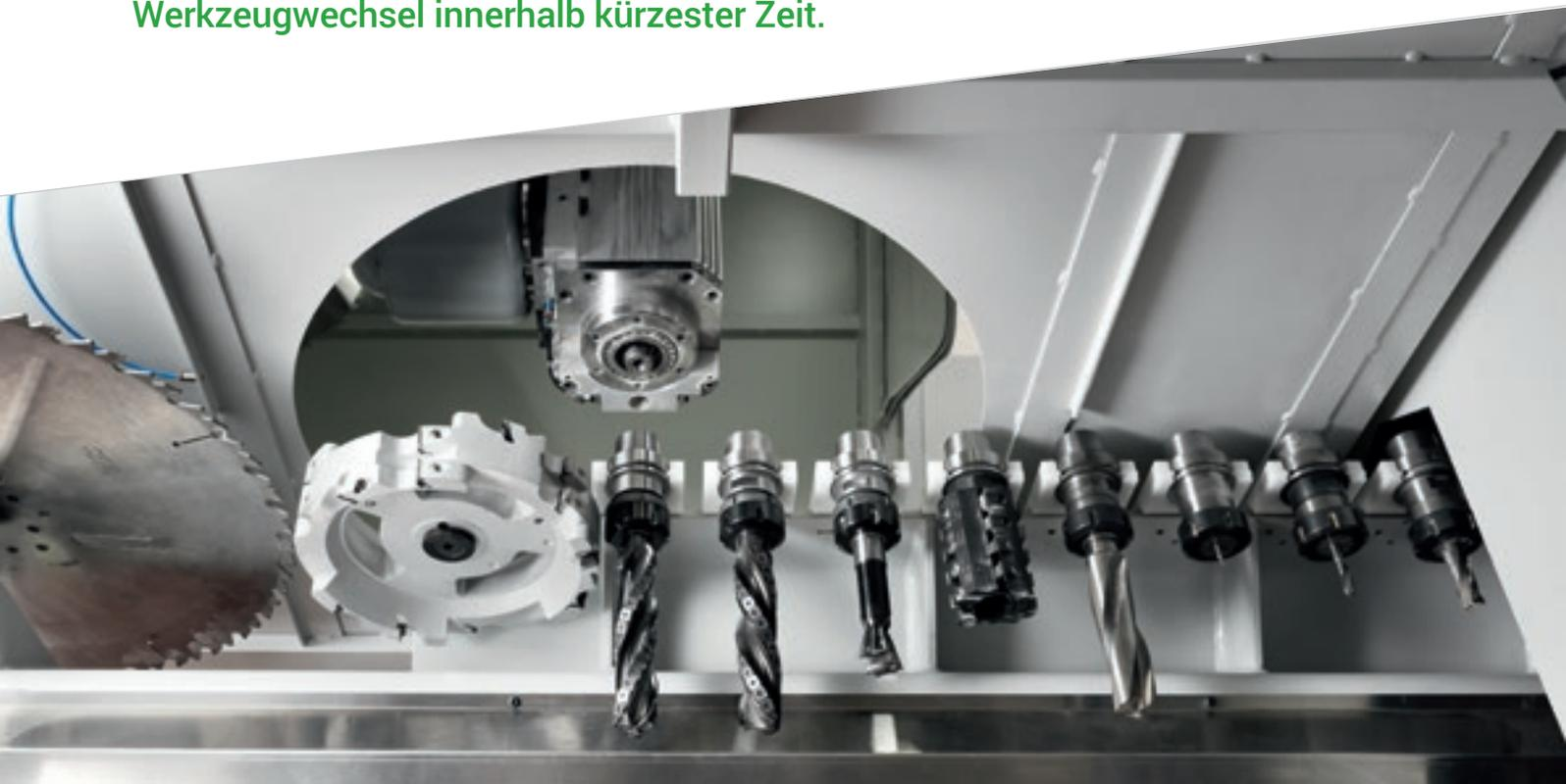
Die Hauptfräseinheit verfügt über ein spezielles Werkzeugmagazin mit 12 Positionen, in dem ein Sägeblatt mit einem Durchmesser von 640 mm und ein Kettenaggregat untergebracht werden können.
