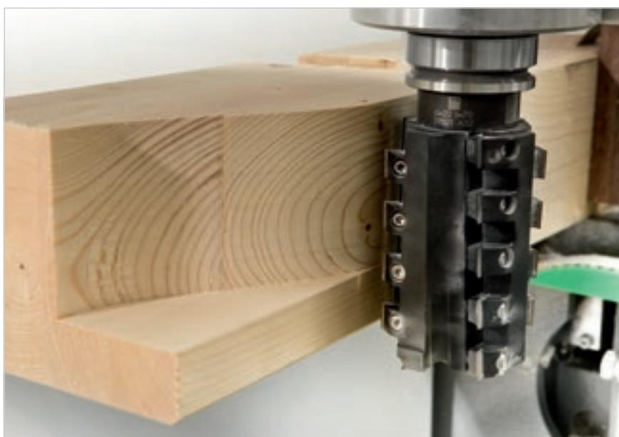
Unità di fresatura a 5 assi, 17kW, in grado di supportare la lavorazione di utensili molto grandi e pesanti grazie all'encoder posizionato sull'asse del mandrino per il controllo dell'assorbimento della corrente in funzione dell'avanzamento dell'utensile.
