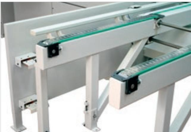
Il buffer, costituito da catene motorizzate dove possono essere accumulati i pezzi, consente di alimentare automaticamente la macchina a ciclo continuo, senza tempi morti.
