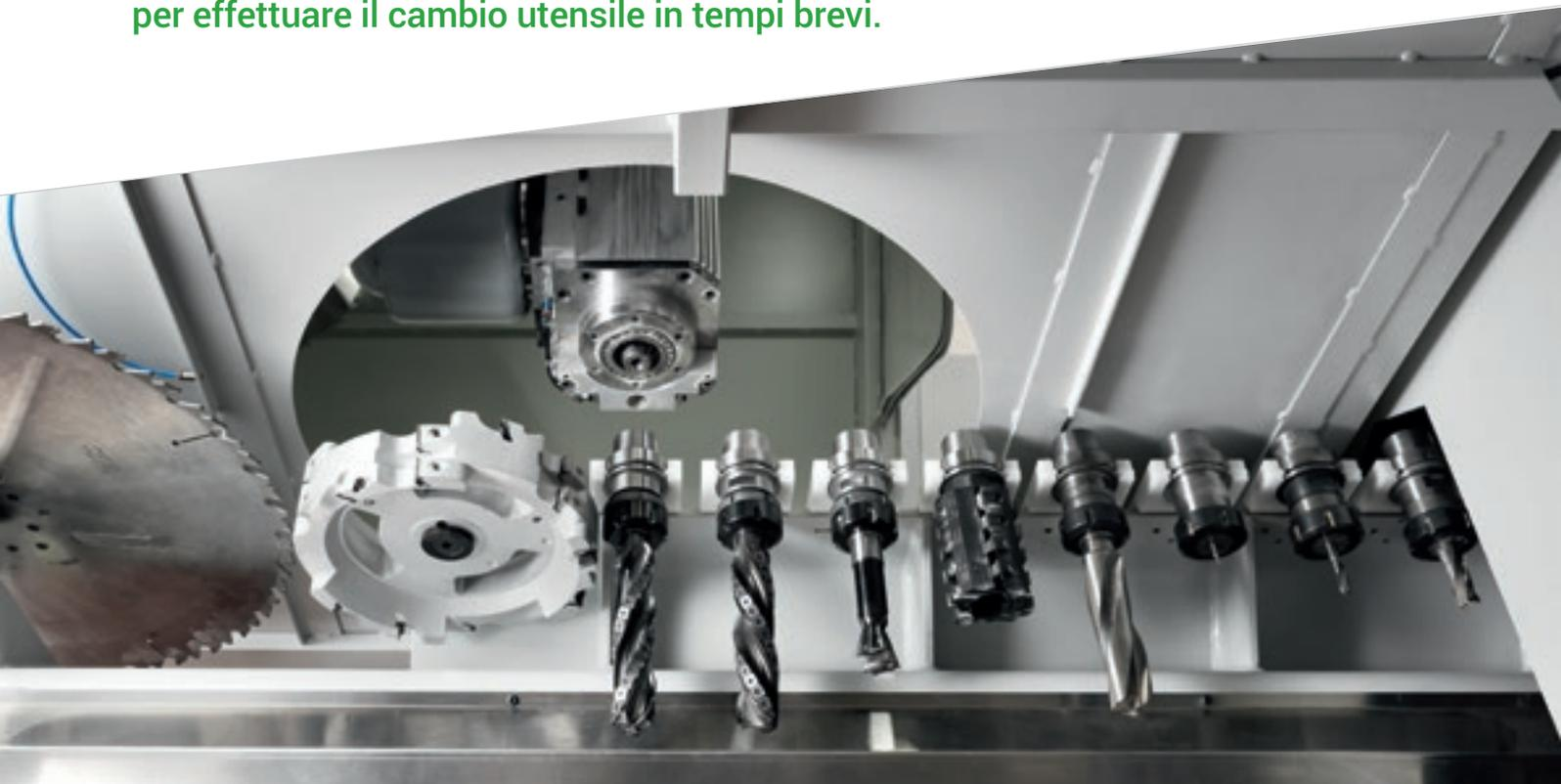
L'unità di fresatura principale dispone di magazzino utensili dedicato a 12 posizioni dove poter alloggiare una lama di diametro 640 mm e un aggregato catena.
