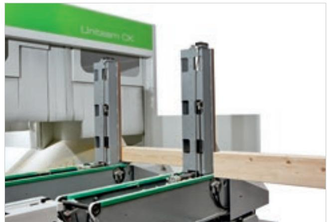
Il sistema di rotazione idraulico a 90° delle morse rende possibile la lavorazione delle sei facce del pezzo senza la necessità di ripresa.
