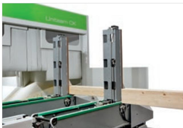
**Гидравлическая система поворота зажимов** на угол 90° делает возможной обработку детали по шести сторонам без необходимости перехвата.
