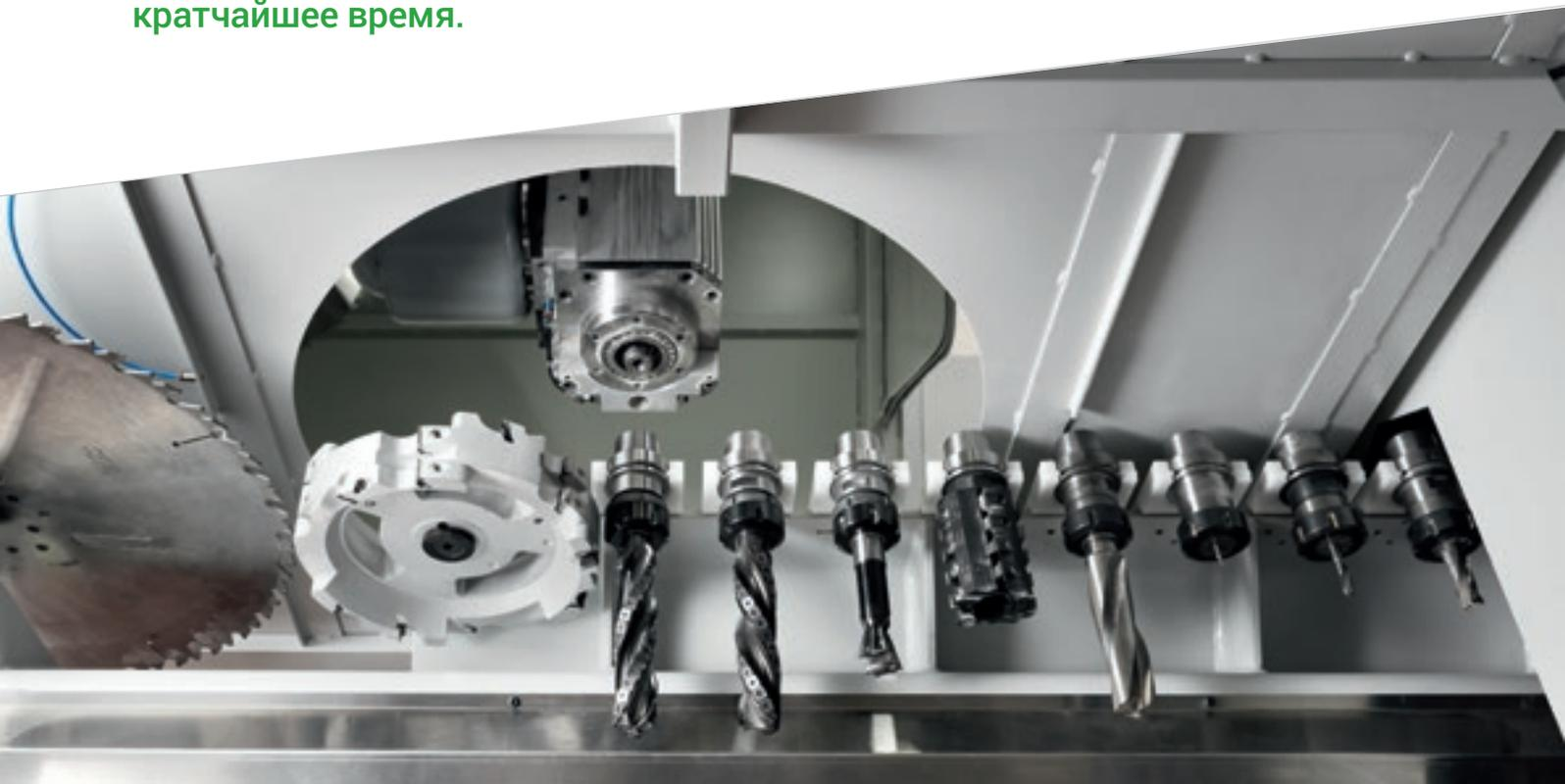
Основная фрезерная голова располагает магазином инструмента на 12 мест, в котором возможно размещать пилу диаметром 640 мм и цепной агрегат.
