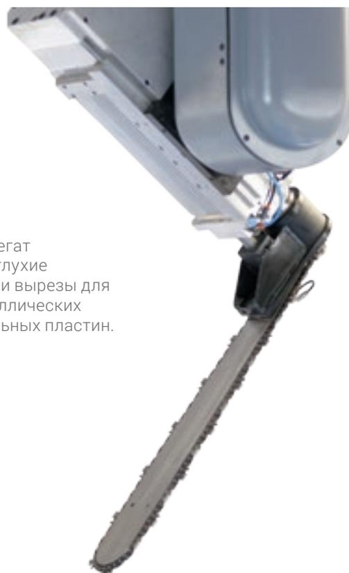
Цепной агрегат исполняет глухие пропилы или вырезы для ввода металлических соединительных пластин.
