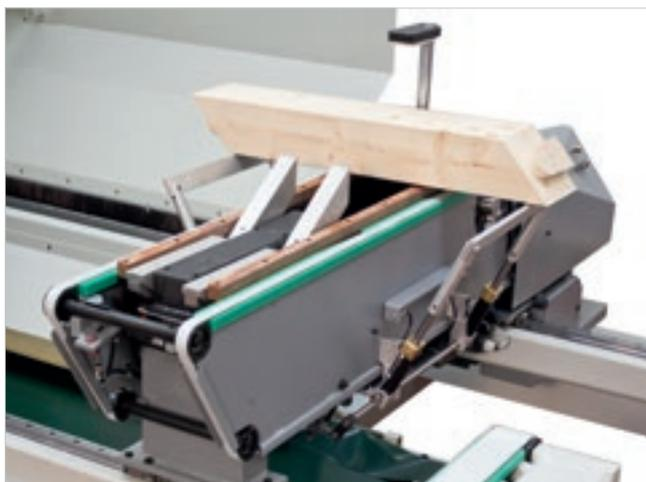
**Система подачи брусьев** представляет собой четыре каретки с гидравлической вертикальной и горизонтальной фиксацией.
