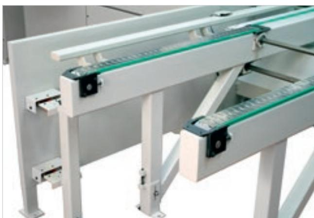
**Буфер**, представляющий собой цепи с электроприводом, на которых возможно размещение деталей, позволяет автоматически непрерывно подавать их в станок без потерь времени.
