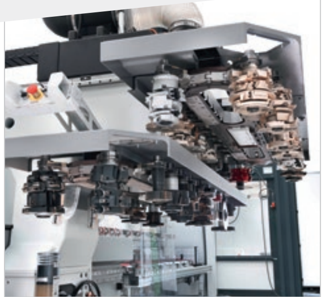
Zweistöckiges Kettenlager mit insgesamt 44 Positionen.
