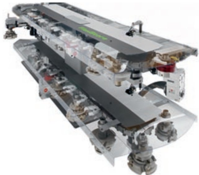
Flexstore-Lager 44, 66, 88 Positionen im Abstand von 180 mm
