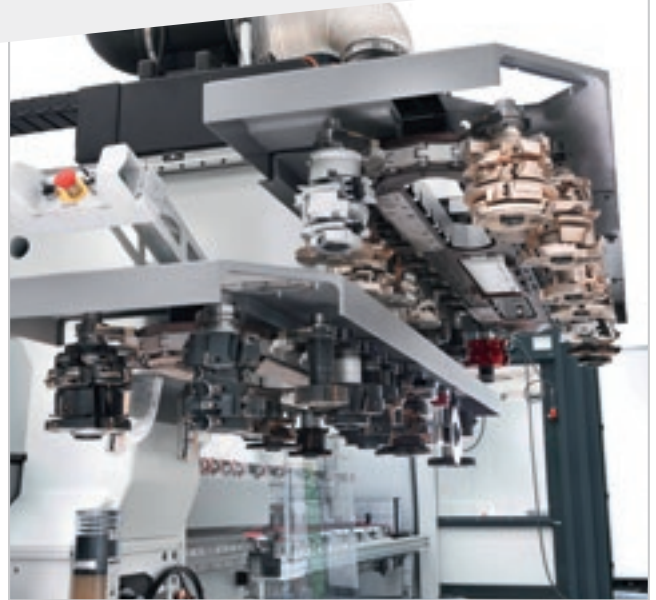
Zweistöckiges Kettenlager mit insgesamt 44 Positionen.
