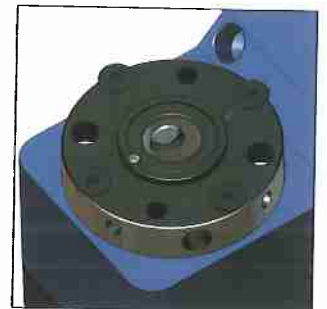
Sägeblattaufnahme Ø30 und Fräser-/ Bohreranahme Weldon Ø16 / Ø20 nach DIN 1835
