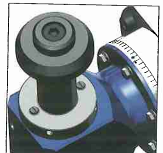
Sägeblattaufnahme Ø30 (Spannbereich 1,5 - 63 mm)
