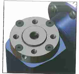
Sägeblattaufnahme Ø30 mit Fräser-/ Bohreranahme Weldon Ø10 nach DIN 1835
