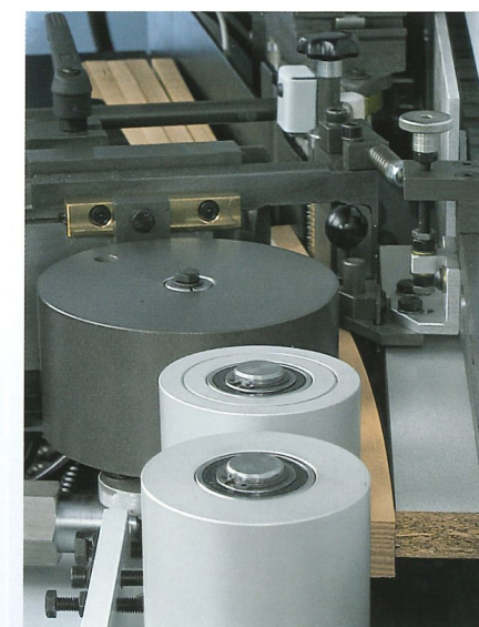
Druckzone Schwere Druckzone (bis 8 mm) für eine optimale Leimfugenqualität.
