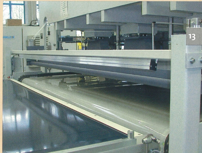
LEGBILDERFASSUNG zur automatischen Druckeinstellung DETECTION OF THE PICTURE for the automatic pressure adjustment
