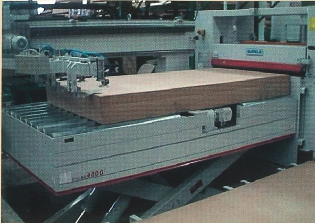
EINSCHUBVORRICHTUNG mit hydraulischem Scherenhubtisch zum taktweisen Beschicken der Anlage INFEE DEVICE with a hydraulic scissor lift table for the stepwise loading of the line
