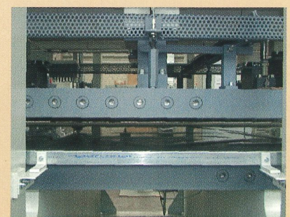
MASSIVE STAHLHEIZPLATTEN mit Druck-Verteilstücken SOLID STEEL HEATING PLATENS with pressure distributing pieces
