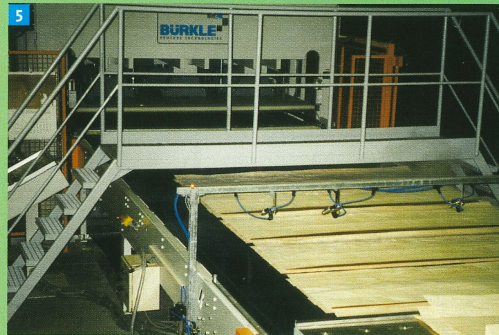
5 Kurztakt-Durchlaufpresse mit Beschickband und Befeuchtungseinrichtung Short-cycle throughfeed press with loading belt and pre-moisterizing area.
