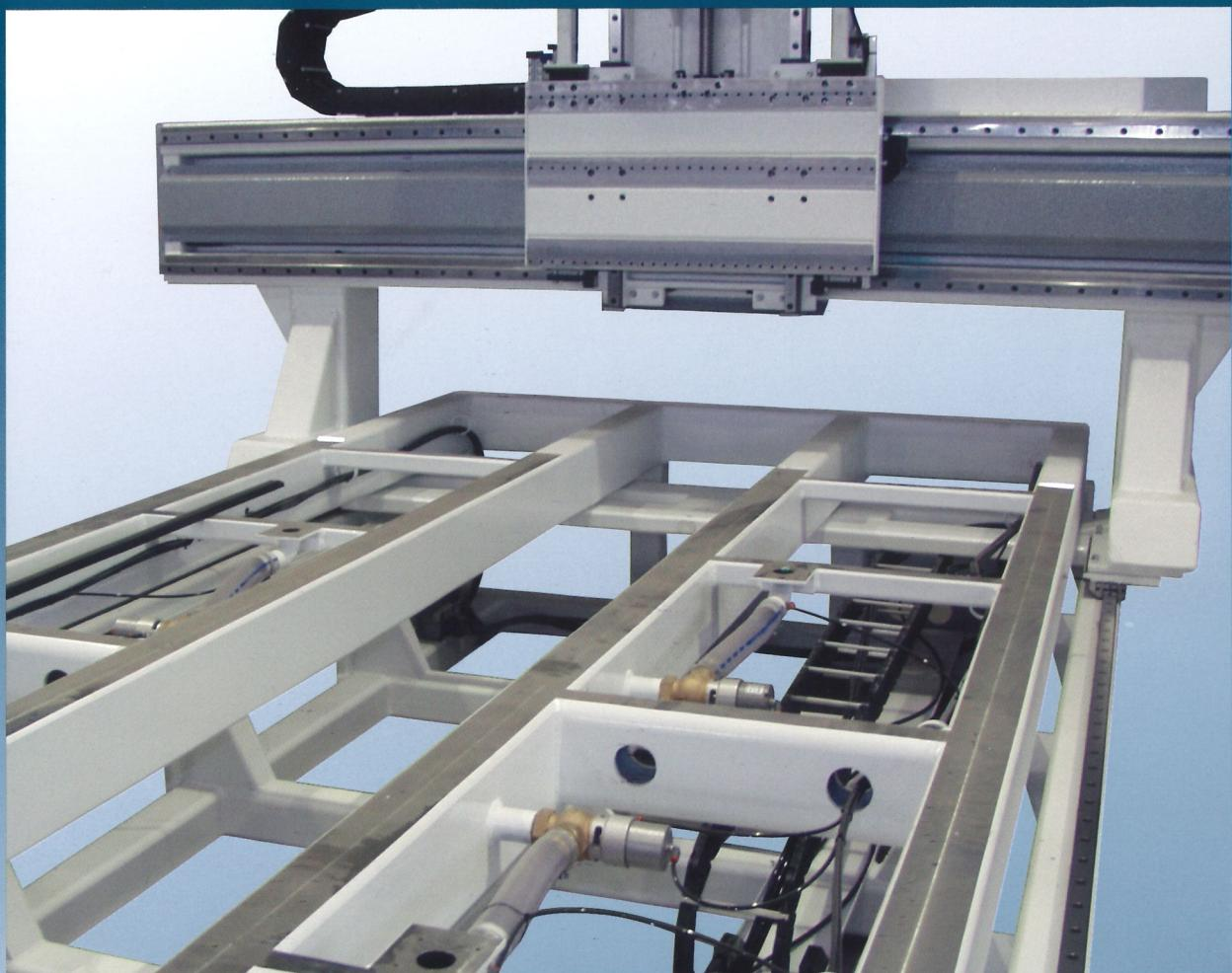
La struttura a ponte mobile crea un anello chiuso. Le lamiere tubolari di grande spessore eliminano qualsiasi tipo di vibrazione. Le guide lineari e i pattini usati sono i migliori del mercato.
