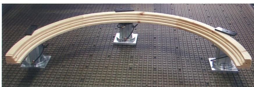
Esempio di bloccaggio per archi ed infissi sul piano FPM.
