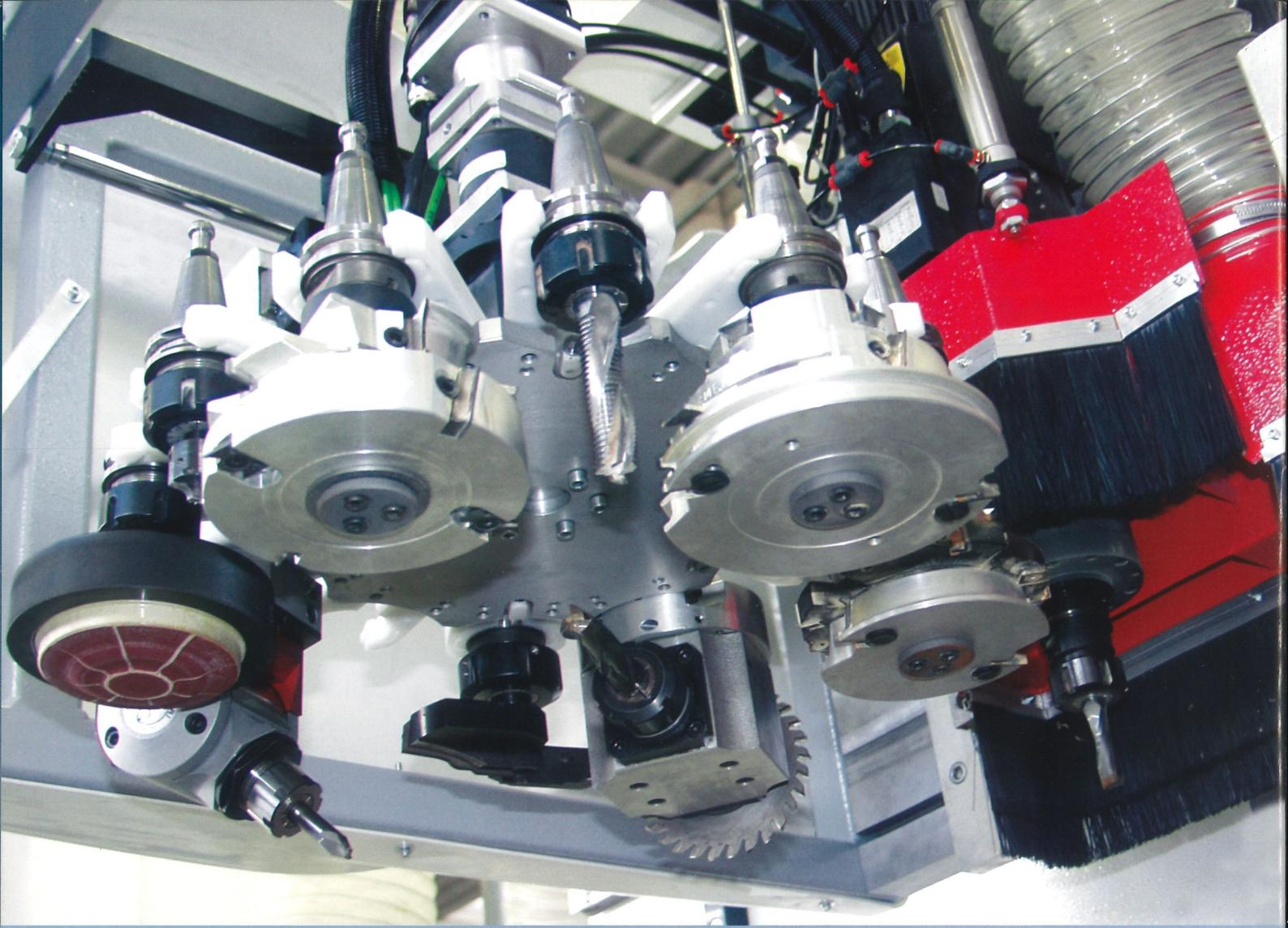
Cambio utensile attrezzato per la lavorazione di infissi in legno.
