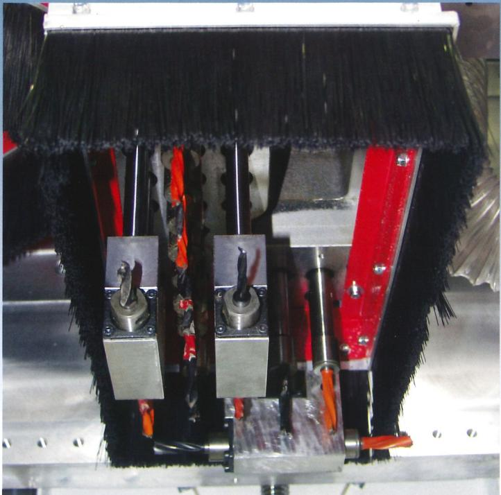
*Motore dotato di asse C (Rotor) 360° in continuo con cambio utensile automatico attacco HSK F63.*
