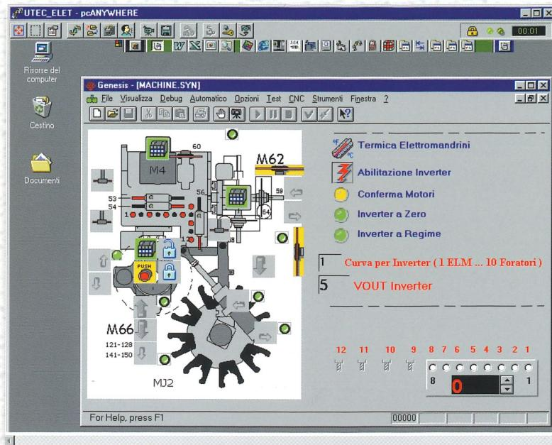
**PC-ANYWHERE:** permet la connexion à distance entre l'ordinateur de la machine et le Centre Assistance Busellato
