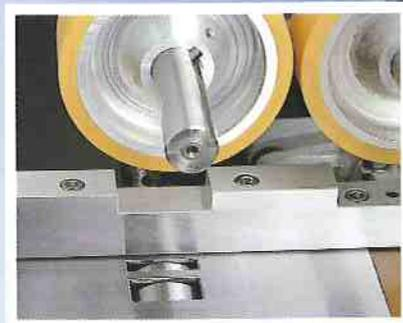
**Avanzamento con riduttori a vite senza fine e giunti cardanici per un trascinamento regolare: rullo di traino inferiore di serie per un'uscita sicura dei pezzi.**
