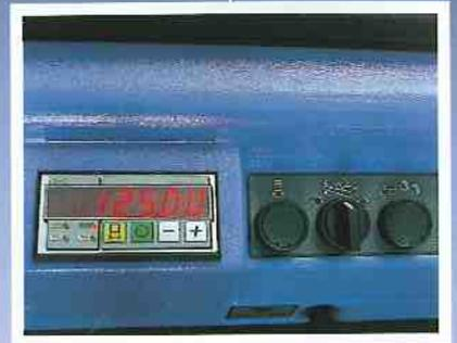
**Indicatore digitale elettronico DUPLEX sul 4° albero: aggiornamento automatico dell'altezza del pezzo finito al cambio del diametro utensile. Vengono eliminate tutte le operazioni manuali di messa a punto con notevole risparmio di tempo nelle fasi di attrezzaggio-macchina.**
