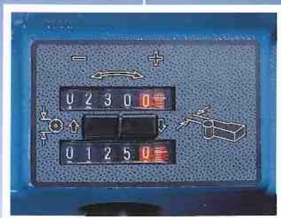
Indicatore digitale meccanico a doppia lettura sul 3° albero con aggiornamento automatico della misura della larghezza del pezzo finito a variare del diametro utensile. Elevata semplificazione delle operazioni di attrezzaggio-macchina (di serie).
