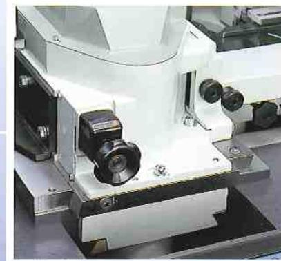
Indicatore digitale meccanico per la regolazione contemporanea dei pressori in entrata e in uscita del 3° albero e della piastra del piano con riferimento al diametro dell'utensile per una rapida regolazione. Volantino regolazione piastra 2° albero.
