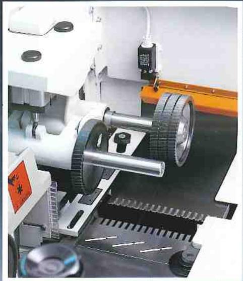
Alberi ad alta precisione senza vibrazioni con anello raschiapolvere nel cilindro del movimento assiale, per una lubrificazione senza polvere e una costante scorrevolezza. Raccordi per lubrificazione centralizzata.
