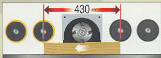
Già nella versione standard, la macchina può lavorare pezzi molto corti, fino a 430 mm. Questo grazie allo speciale dispositivo di traino ad interasse ridotto presente nel gruppo operatore orizzontale superiore. L'uscita di ogni pezzo è garantita dalla presenza rulli gommati motorizzati nel piano di lavoro.
