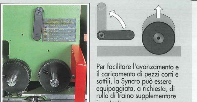
Per facilitare l'avanzamento e il caricamento di pezzi corti e sottili, la Syncro può essere equipaggiata, a richiesta, di rullo di traino supplementare in entrata.
