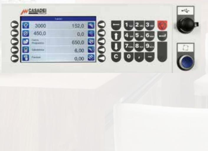
Controllo numerico, di serie sulle versioni "A" con schermo LCD da 7" in formato 16:9. Possibilità di controllare tutti gli assi della macchina, tastiera alfanumerica, possibilità di memorizzare fino a 300 programmi di lavorazione, controllo della velocità di rotazione della lama principale (se la macchina è equipaggiata con inverter), porta USB.
