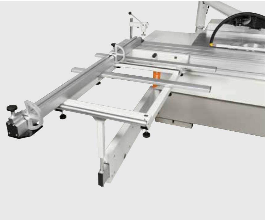
Guida per tagli in quadro con visualizzatore elettronico digitale su ogni battuta (3) e sistema di lettura della posizione delle battute su banda magnetica. Disponibile su richiesta.
