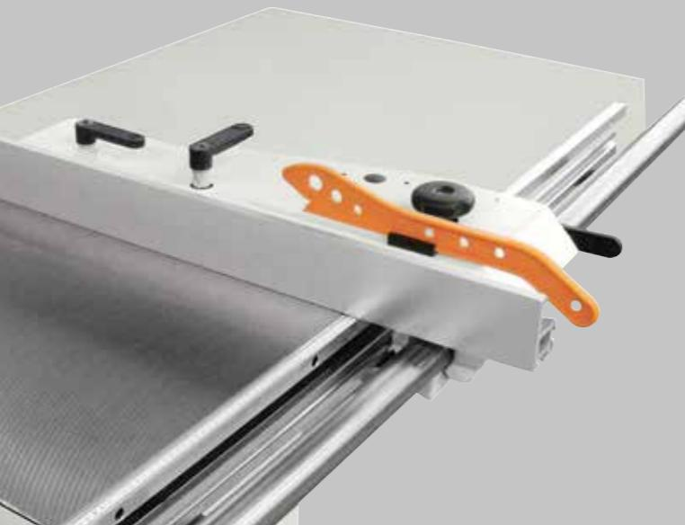
Guida per tagli paralleli molto robusta con regolazione micrometrica tramite cremagliera, e bloccaggio rapido tramite eccentrico. La guida scorre su una barra rotonda in acciaio rettificato ed è ribaltabile.
