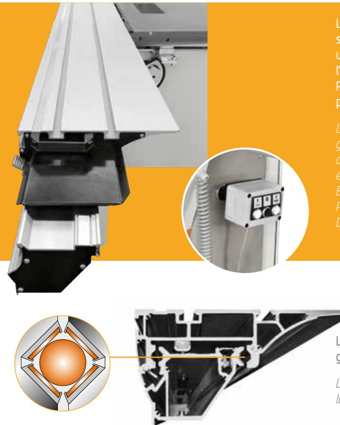
Leader in qualità e precisione, la Casadei da oltre 35 anni utilizza il sistema di scorrimento del carrello con guide prismatiche ad interposizione di sfere, per uno scorrimento dolce e preciso. Il contatto puntiforme tra guida e sfera facilita l'espulsione della polvere.
