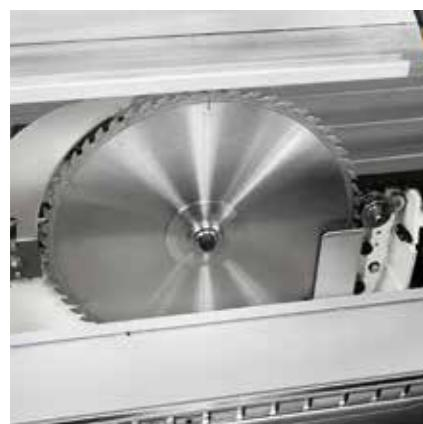
Possibilità di montare lama da 550 mm senza incisore montato. (opzionale).
