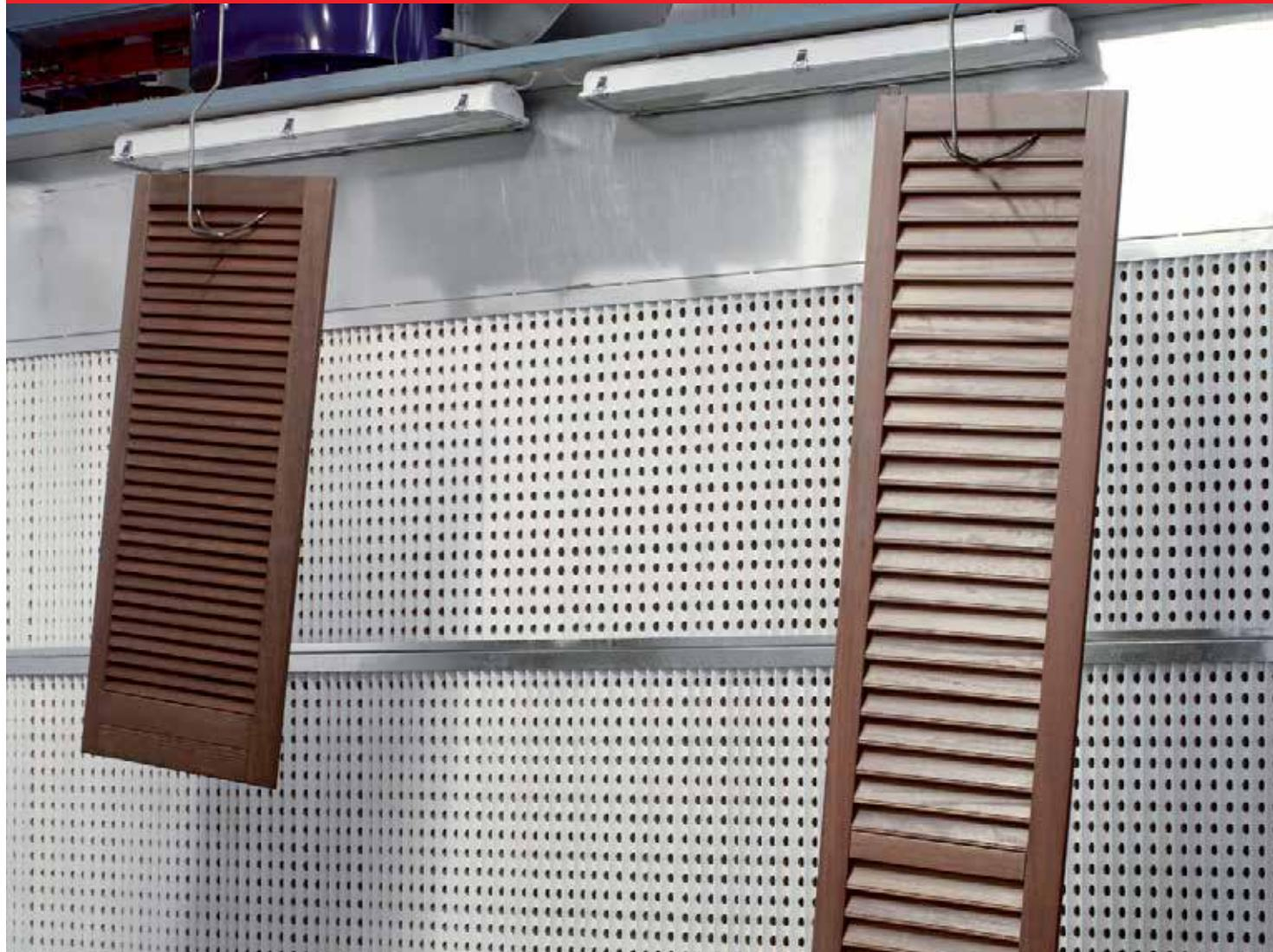
Le cabine di verniciatura a secco sono provviste di filtri frontali verticali in carta speciale ad alta efficienza e filtro interno orizzontale in poliestere, che consentono il massimo rispetto delle condizioni di lavoro degli Operatori, anche con funzionalità Energy Saving.
