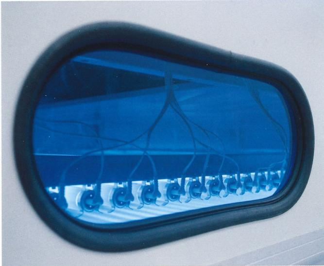
Lampade TL per la gelificazione di vernici trasparenti e pigmentate.
