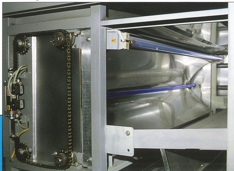
Das ECOGEL-System ist ein patentiertes Cefla-System, welches im Trocknungsprozess von Polyester-UV-Lacken benutzt wird, die im Gieß- oder Spritzverfahren aufgetragen werden. Das System besteht in einer Emission von UV-Strahlen mit progressiv steigender, regelmäßiger und kontrollierter Leistung bei allmählichem Werkstückvorschub.
