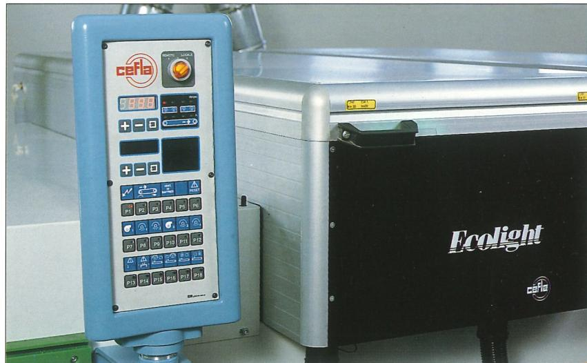
◀ **Die obere Abdeckhaube** ermöglicht, zusammen mit dem Schwenken der Reflektoren, eine einfache Wartung und, wenn nötig, eine leichten Austauschen des Strahlers.
