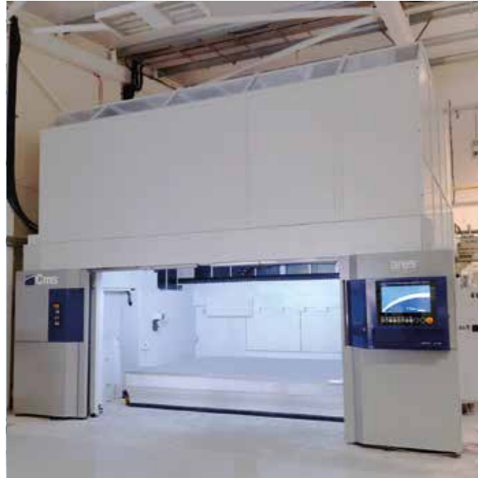
Cabina integrale fonoassorbente per il contenimento polveri, completa di illuminazione interna
