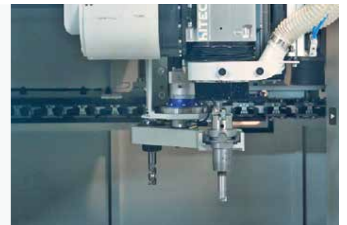
Magazzino a catena con scambio rapido
